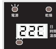
※発酵中は上記例のように、表示パネルに「残り日数・残り時間・庫内温度」が繰り返し表示されます。
