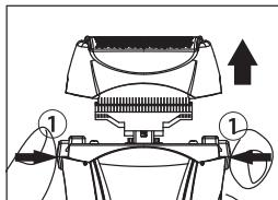
外刃フレーム脱着ボタンを押して外刃を外します。
